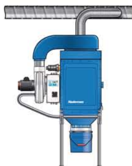
Talna montaža s priklopom na kanal in ventilatorjem
