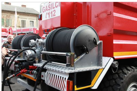
Vozilo ima vgrajeno posebno električno črpalko s 500-litrskim rezervoarjem vode, ki je namenjena samoreševanju, če se mora vozilo zaradi ogroženosti evakuirati.
